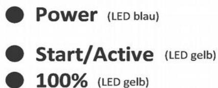
Das Anzeigefeld ist mit Melde - LEDs ausgestattet. Folgende Bedeutung / Eigenschaften weisen diese Elemente aus:
